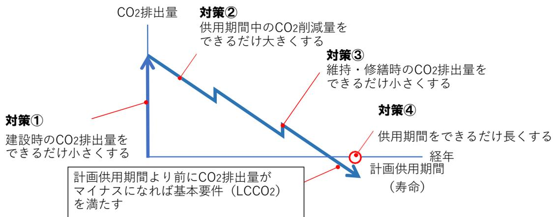
図2 基本要件(LCCO<sub>2</sub>)判定の概念図
