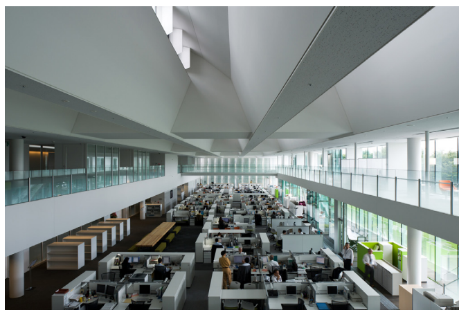
写真3.3-10-1：トップライトによる採光の例（大林組技術研究所）
